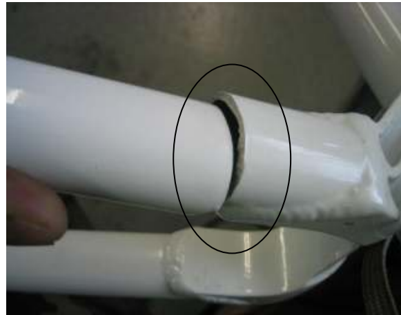
チェーンステー部の破断状況
