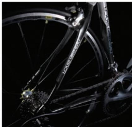
カーボンフレームを採用したトップモデルがこのRSSです。乗り心地と路面追従性を高めるためリヤステーを湾曲することによって、レースはもちろんのこと、ロングライドでもストレスなく楽しめるモデルです。フルモデルチェンジによって操作性を大幅に高めたハイエンドコンポ、SHIMANO DURA-ACEを採用し、カーボンフレームの高性能をさらに引き出しています。
