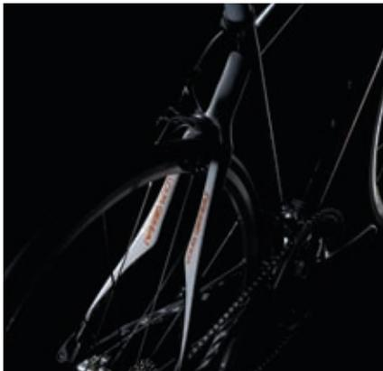
モノコックカーボンフレームを採用したロードバイクです。湾曲したトップチューブや特徴的なステアー形状が施され、路面から来る衝撃を吸収する設計によって長距離でも快適な走りを可能にしています。SHIMANO ULTEGRA SL コンポや MAVIC KSYRIUM EQUIPE ホイールの採用で、レースからロングライドまで幅広く楽しめる高性能を実現しました。サイズによってクランク長を変えるなど、フィッティングにも妥協はありません。
